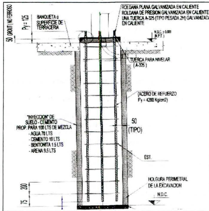
Figura IV.2.2 Cimentación poste de 9 a 11 metros de altura
