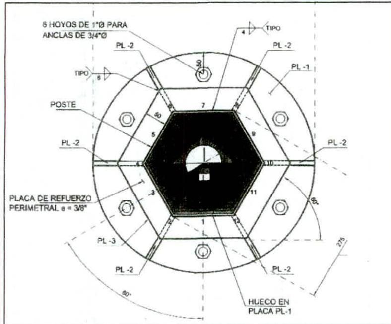
Figura IV.2.6 Base Metálica de poste de 9 a 11 metros
