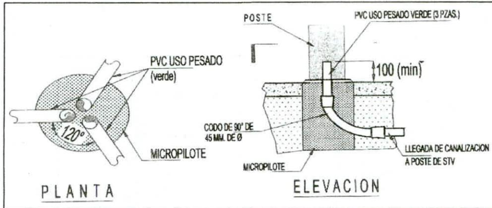
Figura IV.2.5 Detalle de Acometida al poste de 9 a 11 metros
