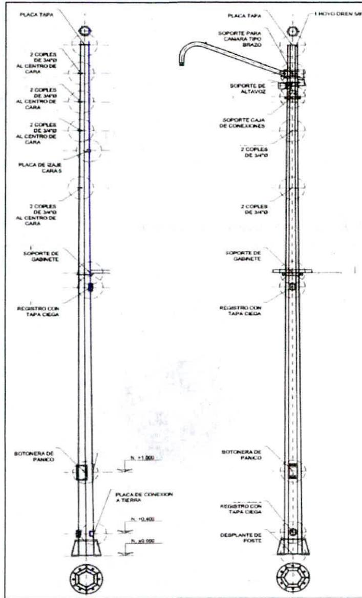
Figura IV.2.7 Alzado de poste con geometría
