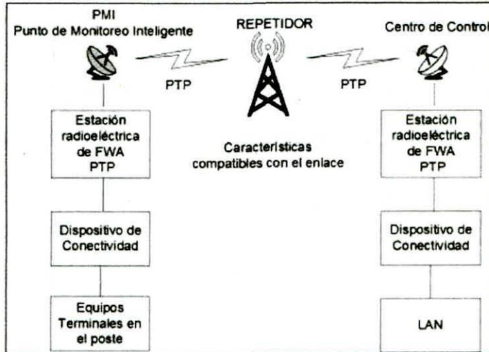
En la Figura 4 se muestra un esquema de enlace Punto a Punto con un repetidor entre el PMI y el centro de control.
