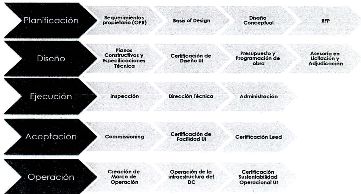
Ilustración 1 Fases en la Vida de un Data Center
