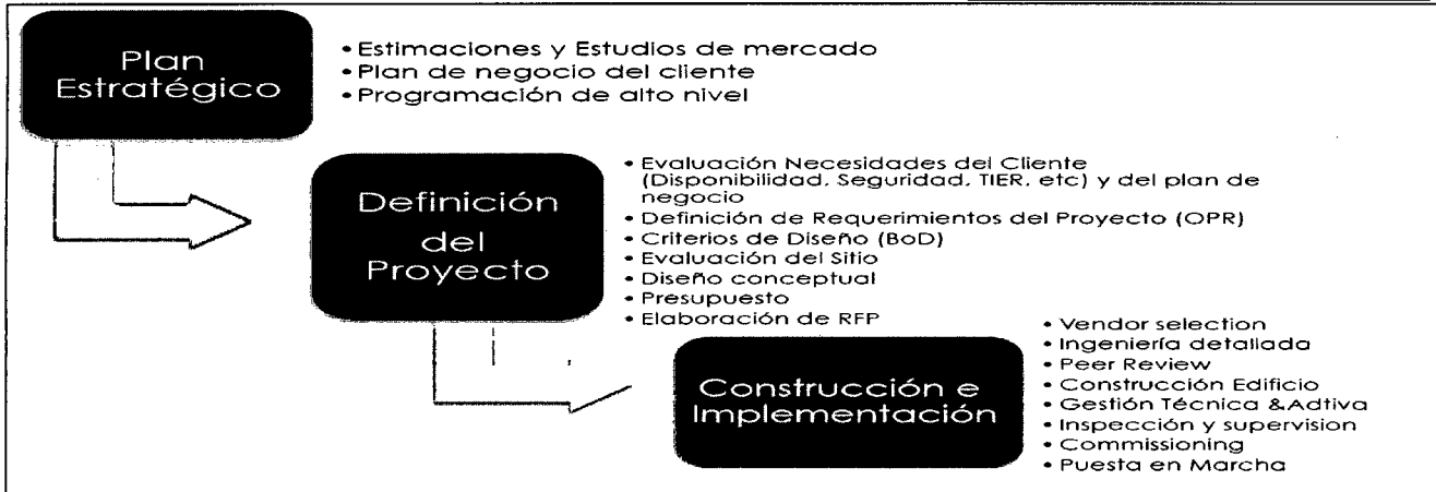
Ilustración 2 Desarrollo de Data Center
